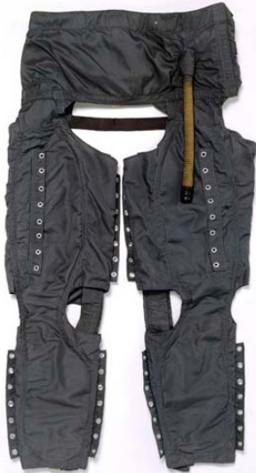
Противоперегрузочные костюмы помогают летчикам выдерживать интенсивные нагрузки
