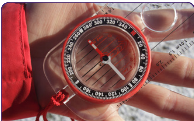
Компасы реагируют на магнитное поле Земли
